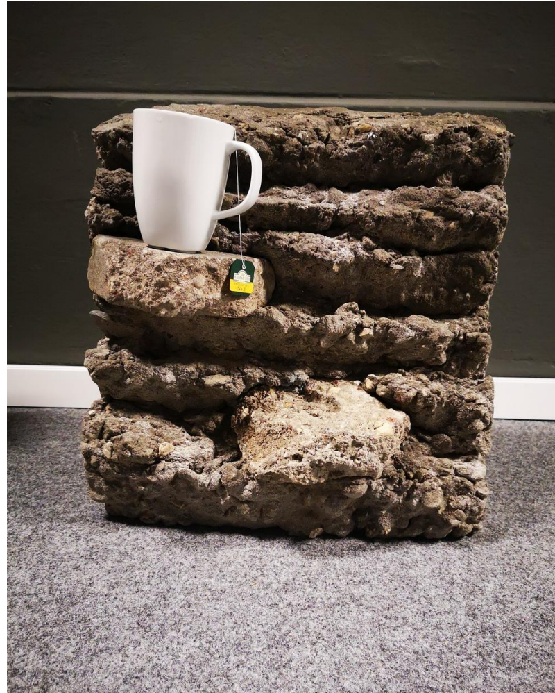
Próbki gruzobetonów wykonane na potrzeby projektu, 2020. Fot. Marcin Maraszek
