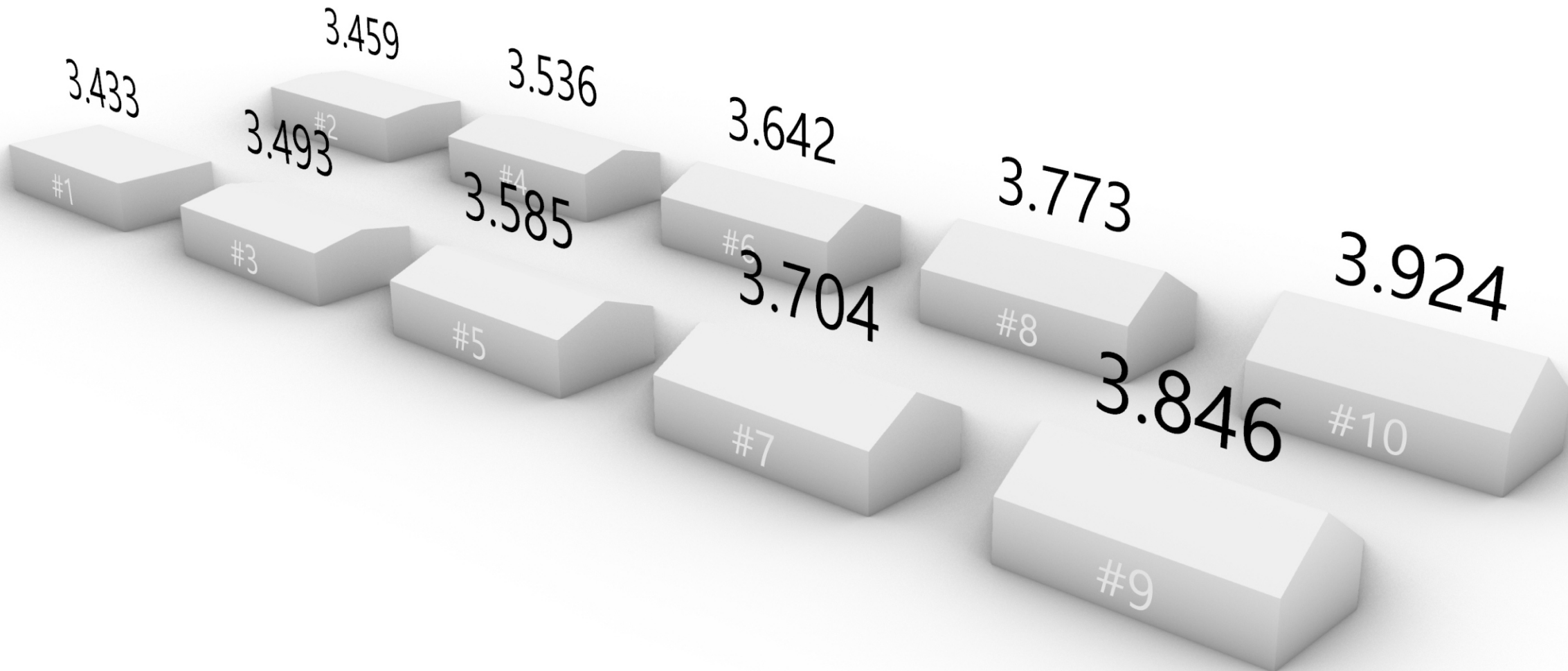
Figure. 12-sto elementowy fragment katalogu rozwiązań problemu współczynnika A_{om}/A_{temp} dla projektowanego budynku. W porównaniu do klasycznej metody obliczeniowej A/V , tego typu kalkulacja dała odwrotne wyniki - najgorszym rozwiązaniem jest budynek o największym poddaszu nieużytkowym.
